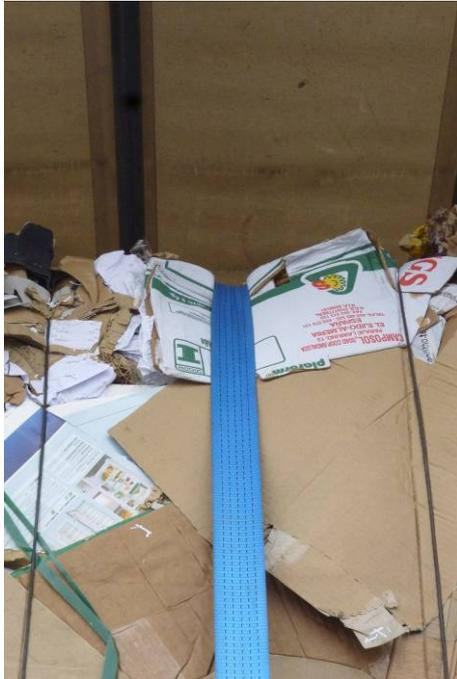
**Bild 5: Einschneiden (Stabilisieren) des Zurrgurtes ins Altpapier**
