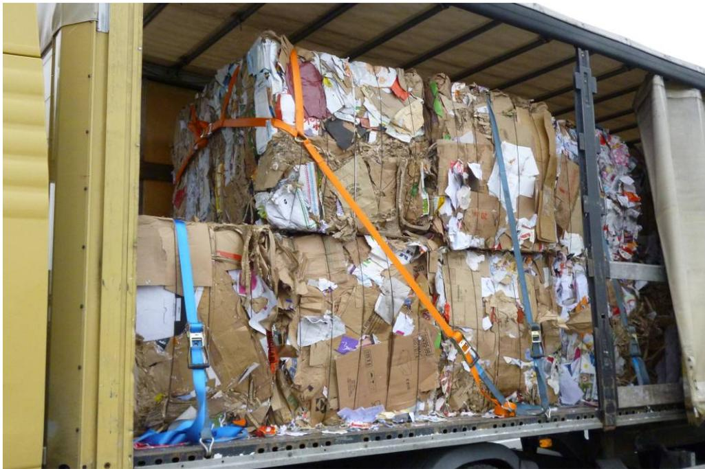
**Bild 4: Kopflashingsystem**
