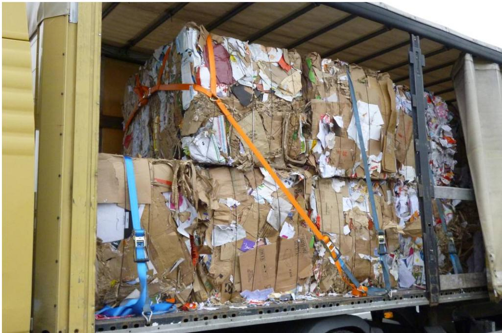
**Bild 7: Kopflashingsystem**
